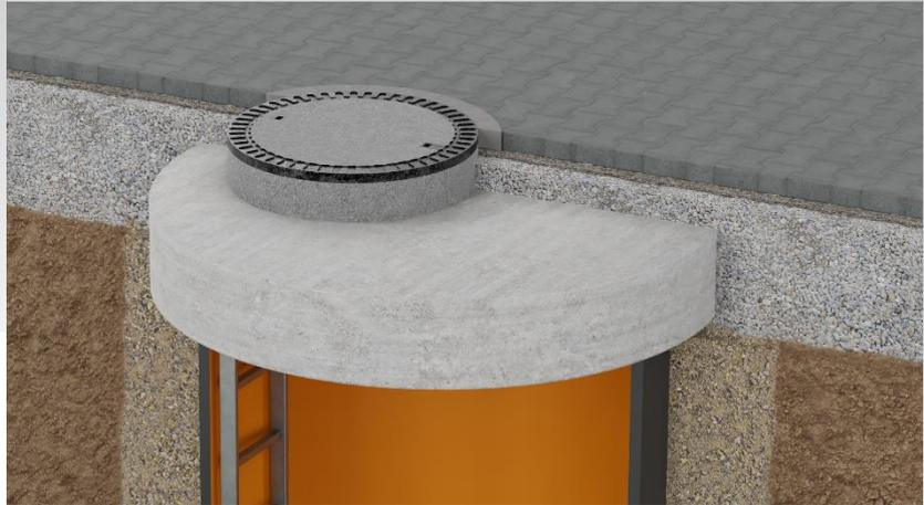
Der Aufbau bei stehenden Wickelrohrschächten ist mit einer Betonkopfplatte vorgesehen, die bauseits auf das Rohr aufgelegt wird. Die mitgelieferte Begu Abdeckung in einer speziellen tagwasserdichten verriegelbaren, Ausführung wird dann in eine dafür vorgesehene Vertiefung eingedichtet. Zur Höhenanpassung können handelsübliche Ausgleichringe verwendet werden.
